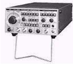
FG-350は、0.1Hz～10MHzの周波数帯域で、正弦波、三角波、方形波（対称、非対称）、直流、FM、AM（正弦波）およびスイープなど、各種の機能を備えた、小型軽量の信号発生器です。出カインピーダンスは50Ωであり、50Ω負荷に対して10Vp-p以上、出力端開放にて20Vp-p以上の出力電圧が得られます。この出力電圧は、アッテネータにより、最大1000：1以上減衰させることができますので、アッテネータの使用により10mVp-p以下～10Vp-p以上（50Ω負荷時）の広範囲にわたり、低ひずみ出力が得られます。
