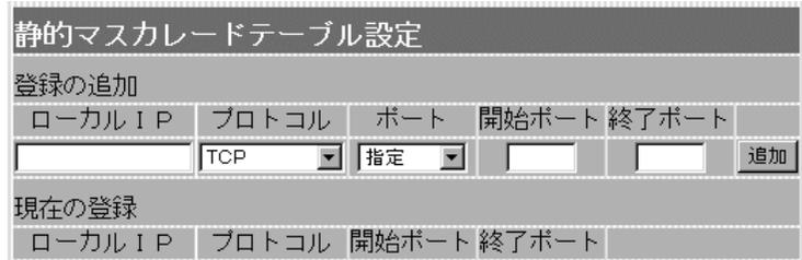
マスカレードIP(ルータグローバルIP)に対して、アクセスしてきたパケットをプロトコルにより判定し、ここで指定したプライベートIPアドレスを割り当てたローカル端末へアドレス変換します。最大32個のマスカレードテーブルを設定できます。
