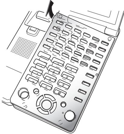
1. カバー上部左側の突起部を指で持ち上げ、カバーとキーシートを取り外します。
