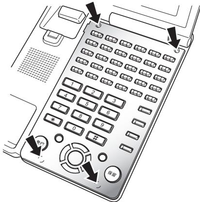
3. キーシートとカバーを元の位置に置き、カバー4箇所の突起を押して取り付けます。
