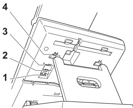
3. 電話機本体の窪みにプレートの先端を差し込みます。
