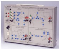
ITF-202Aは、演算増幅器を利用して各種のアナログ回路を設計しその機能、使い方、性能測定の基本等を学習することができます。基本実習から実用回路、応用的な回路までを、容易に行うことができます。
