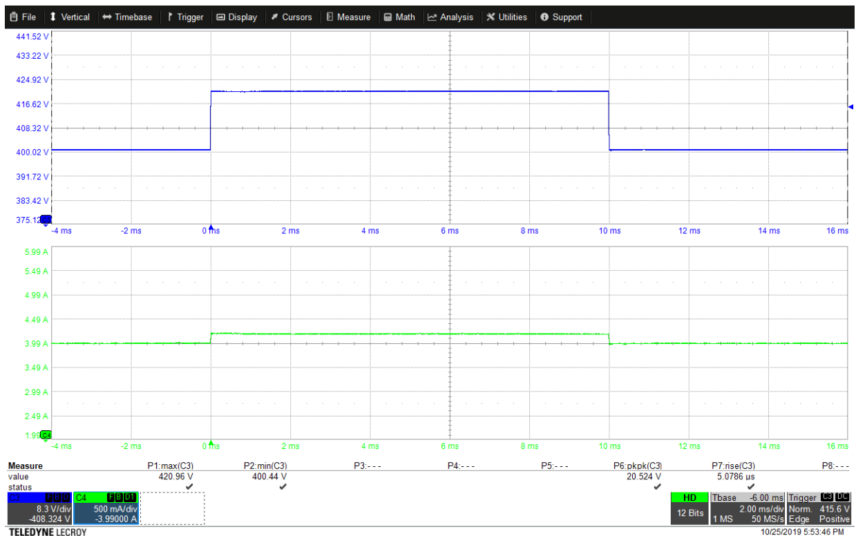
図 5：C3：V_load, C4：I_load, 高速ロードダンブ試験
