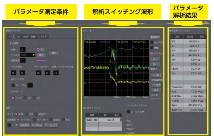
スイッチング動特性解析プラグインソフトウェアの画面イメージ
