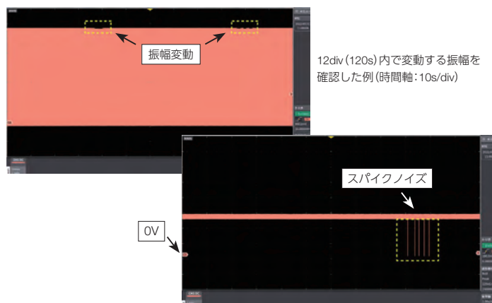
スパイクノイズをピーク検出機能で検出した例(時間軸:1s/div)
